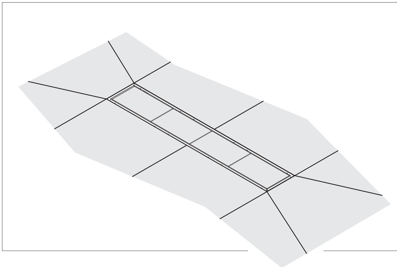
**SV** Montera klinker och foga golvet. Se över golvrännan att ingen betong, spackel etc finns i produkten. Montera vattenlås/silkorg och lägg i galler/sil. För att undvika lukt från avloppssystemet, fyll vattenlåset med vatten.
